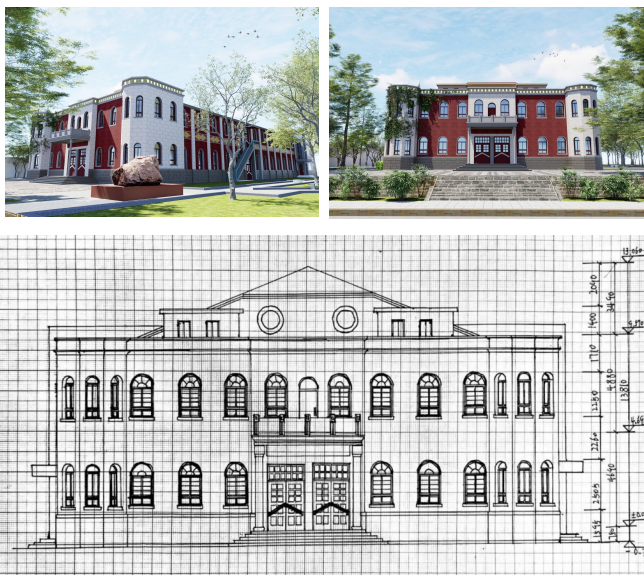
图 24 山东农业大学西礼堂二维测绘图与三维信息模型
