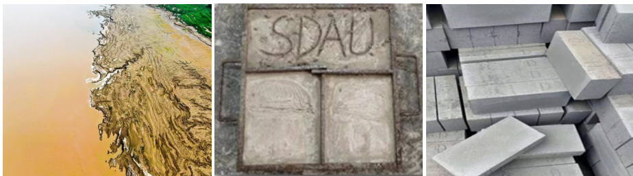
图 19 碱激发黄河泥沙砖
